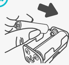
· Instale 3 baterías AA e ingrese el soporte asegurando buen contacto.
